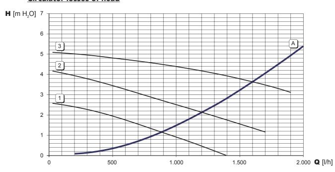
$\begin{bmatrix} 1 \end{bmatrix} \begin{bmatrix} 2 \end{bmatrix} \begin{bmatrix} 3 \end{bmatrix} = Circulator speed$
