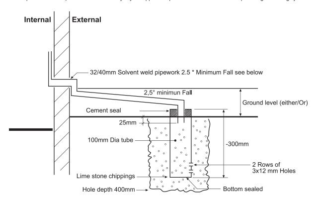
fig. 28 - Condensate drain
